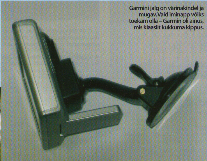
Galileo pikk kandejalg lubab küll vaatenurka mugavalt seada, ent pika varre otsas seade sõidul vibreerima.
